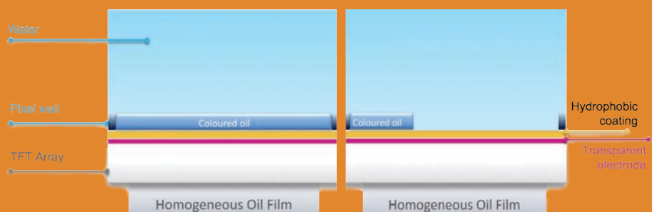
Een illustratie van de situatie waarin de druppel een pixel bedekt (links) en de situatie waarbij hij weggedrukt wordt (rechts)
