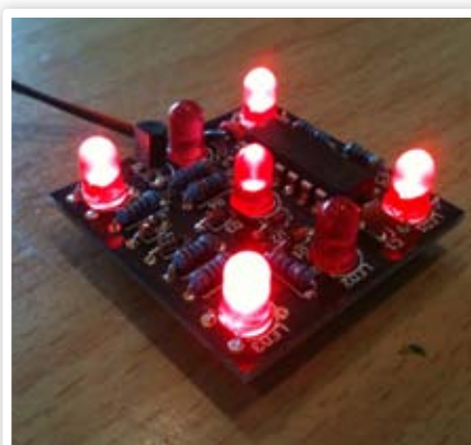
De vernieuwde, vierkante printplaat met grotere LED's.
